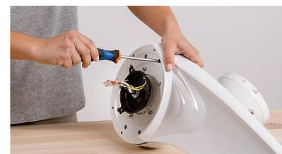
1.3 Desmonta los tornillos de sujeción del plafón o de la placa de iluminación. Después de hacer la conexión debes volver a montarlo a la estructura del ventilador.
